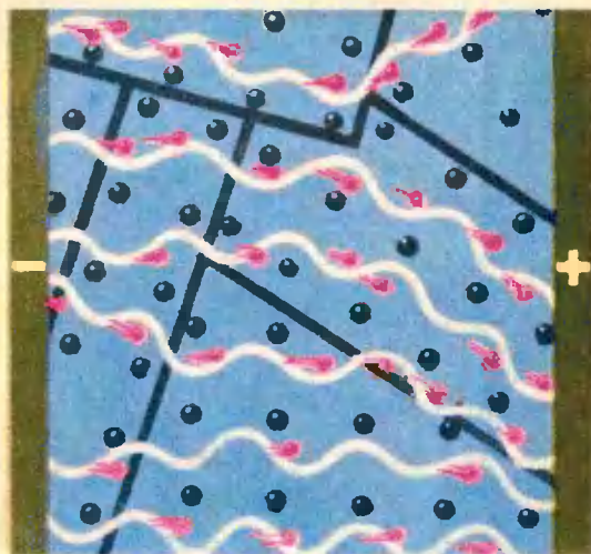
Рис. 3. Схема движения электронов по атомным лабиринтам в поликристаллическом агрегате. Красным цветом показаны электроны.
