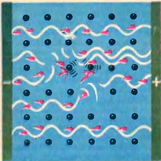
Рис. 5. Первый тип дефектов кристаллической решетки — вакансии (пустые места). Замечательно, что электроны рассеиваются и на вакансиях — нужно ли лучшее доказательство того, что они сталкиваются вовсе не с атомами решетки? Дело в том, что вакансия играет роль отверстия в стенке атомного волновода, нарушающего правильное распространение электронных волн.
