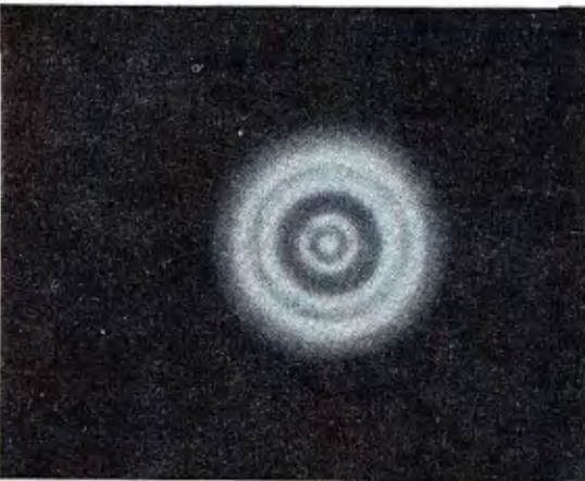
Рис. 7. Дифракция от круглого отверстия. а) Диаметр отверстия 1 мм, R_1=R_2=0,5 м. Красный светофильтр. Отверстие открывает две зоны. В центре черное пятно. б) То же с синим светофильтром. Отверстие открывает почти три зоны. в) Диаметр отверстия 1,5 мм, R_1=R_2=0,5 м. Красный светофильтр. Отверстие открывает немного более четырех зон.
